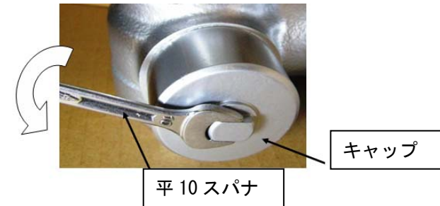
図4 安全弁のキャップの取外し作業
